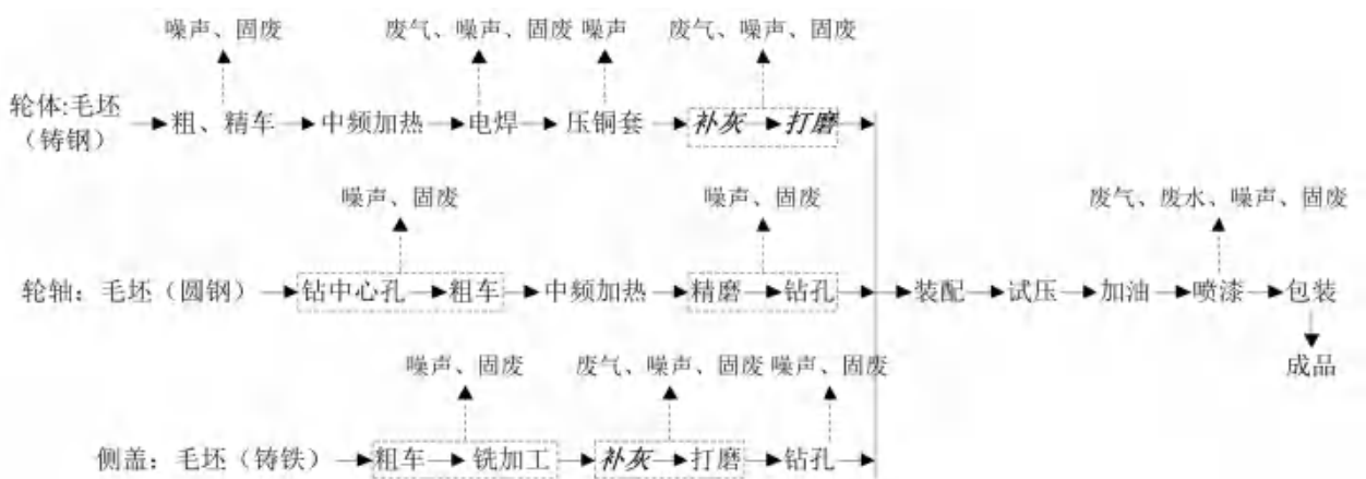
图 3.2-6 支重轮、引导轮生产工艺流程及产污环节
